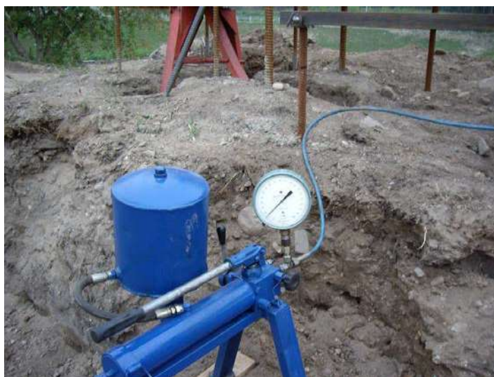
3 pav. Rankinė hidraulinė siurblinė
